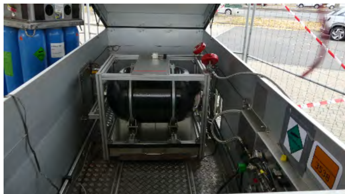
Gravimetrisches Messsystem der Air Liquid Deutschland GmbH zur Prüfung von Zapfsäulen für die Abgabe von Wasserstoff
