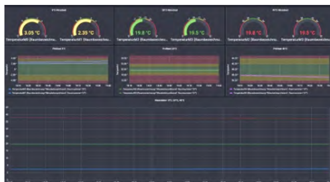
Monitoring der Badtemperaturen durch die Web-Anwendung Grafana
